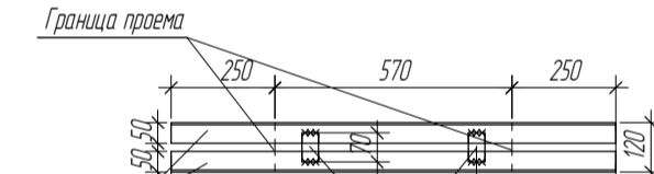
Принципиальная схема металлической перемычки для отв. этажного ЭЩ
